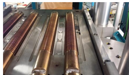
вид пресс-формы с 4 знаками для уплотнений DN50
